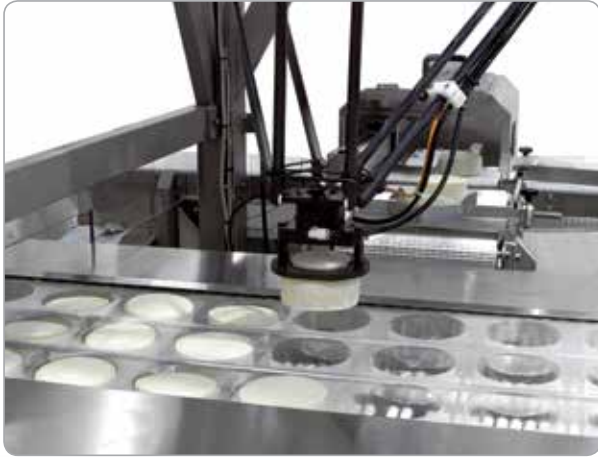
Automation für die Beladung von ganzem Käse
